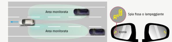
Il sistema "vaipure" interviene monitorando le stesse aree durante l'uscita da un parcheggio. È in grado di rilevare il sopraggiungere di macchine non visibili per il guidatore e lo avverte indicando la direzione dalla quale sopraggiungerà l'auto rilevata.
